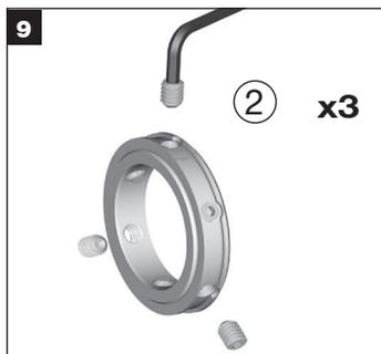
Serrez trois vis sans tête à cuvette (2) de manière homogène avec la clé hexagonale fournie. **IMPORTANT** : une fois toutes les vis de montage serrées à la main, resserrez-les à l'aide d'une clé dynamométrique : Tailles 25 mm à 60 mm (1 po à 2,5 po) entre 5,6 Nm et 6,8 Nm (50 po-lb et 60 po-lb) Tailles 65 mm à 120 mm (2 5/8 po à 4 3/4 po) entre 7,3 Nm et 8,5 Nm (65 po-lb et 75 po-lb)
