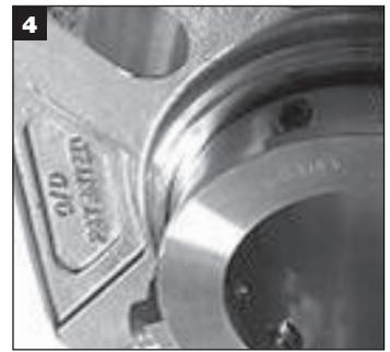
Remontez la pompe et effectuez les alignements de l'arbre et les réglages de l'impulseur nécessaires. L'impulseur peut être repositionné à tout moment, pour autant que les clips de centrage soient en place et que les vis de montage de la garniture mécanique soient desserrées pendant le déplacement de l'arbre.
